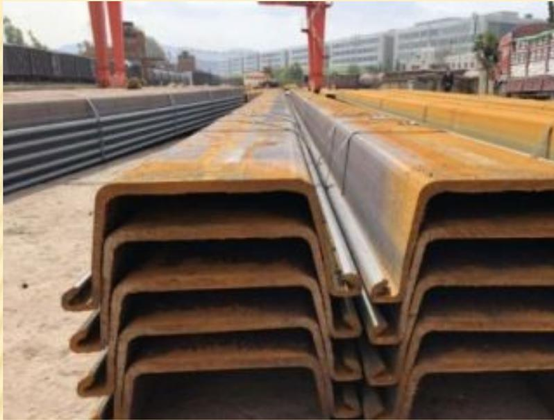
Les palplanches sont des profilés préfabriqués et enfoncés dans le sol afin de créer une paroi de rétenion. Elles sont utilisées pour retenir l'eau ou la terre afin de faciliter les travaux d'ouvrage dans les milieux aquatiques. Le prix de ces constructions se situe aux alentours des 20 €/m<sup>2</sup> et 160 €/m<sup>2</sup>.
